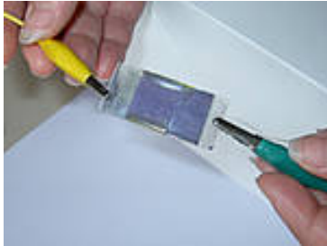
Fertige Grätzelzelle mit zwei Krokodilklemmen
